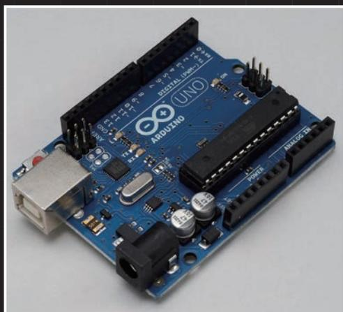
ADKがサポートしている最も手軽なボード「Arduino Uno R3」。電子工作ではよく使われるボードなので、Webなどでもさまざまな情報が入手できる。
