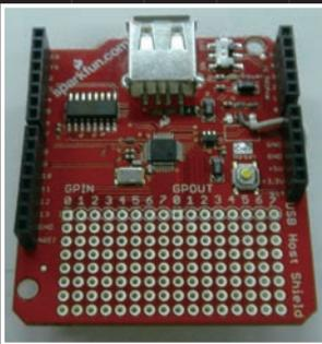
さらに基板上の5Vレギュレータを取り除き、5Vジャンパーのハンダ付けを行うと、USBの接続のみで電源供給が行える。
