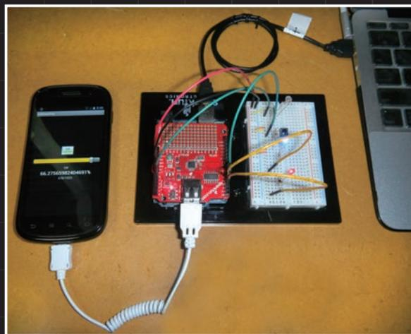
アナログ入力、デジタル入出力を動作確認するためのすべてのパーツを組み込んだ完成例。
